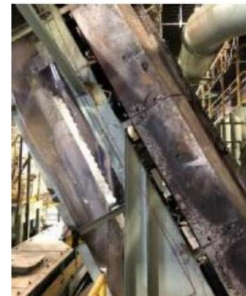
火災で焦げた破碎物コンベヤ(府中市)
