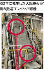
発煙・発火が多い破砕物搬送コンベヤ上に自動散水装置を増設
