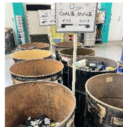
JBRCからのリサイクル処理委託を受ける日本リサイクルセンターでは、リチウム蓄電池の中でもより詳細に選別を行い、自社の国内処理施設でブラックマス化
